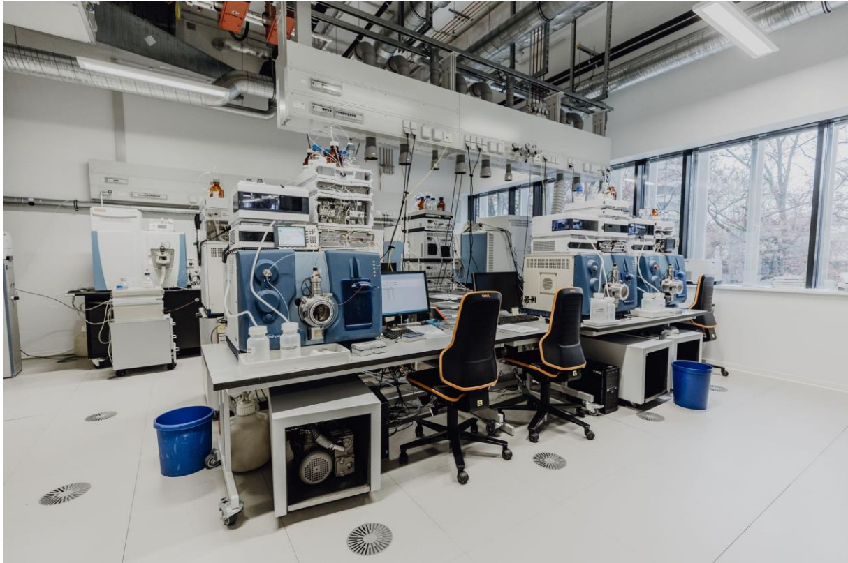
Abbildung 3: Analytischer Messraum im Institut für Biochemie der Deutschen Sporthochschule Köln (Stand Oktober 2018). In dem Messraum befinden sich mehrere GC/MS-MS Geräte (Gaschromatographie/Massenspektrometrie) sowie im Vordergrund mehrere LC/MS-MS Geräte (Flüssigkeitschromatographie/Massenspektrometrie). (Foto: Deutsche Sporthochschule Köln)
