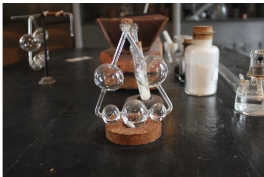
Abb. 5: Der berühmte 5-Kugel-Glasapparat von Justus Liebig für die Elementaranalyse. (Foto: Pauline Hamscher)
