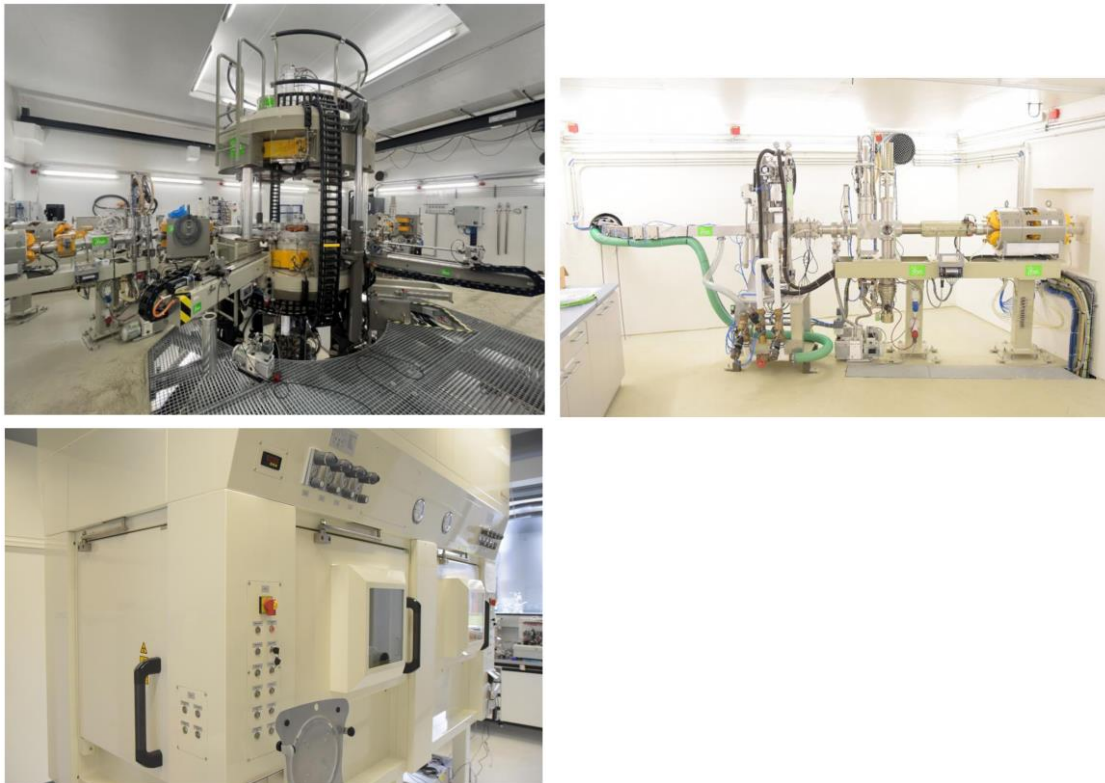
Abb. 3a-c: Teilchenbeschleuniger (Zyklotron) für die Herstellung von Radionukliden am Forschungszentrum Jülich (Abb: Forschungszentrum Jülich GmbH)
